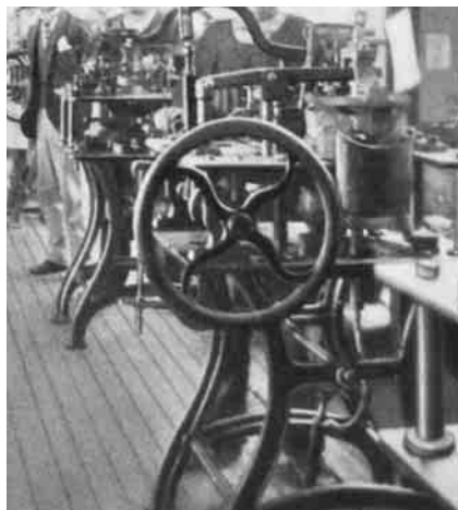
▼ Fundidora de tipos utilizada por Richard Gans en sus instalaciones de la calle Princesa. Hacia 1904.
