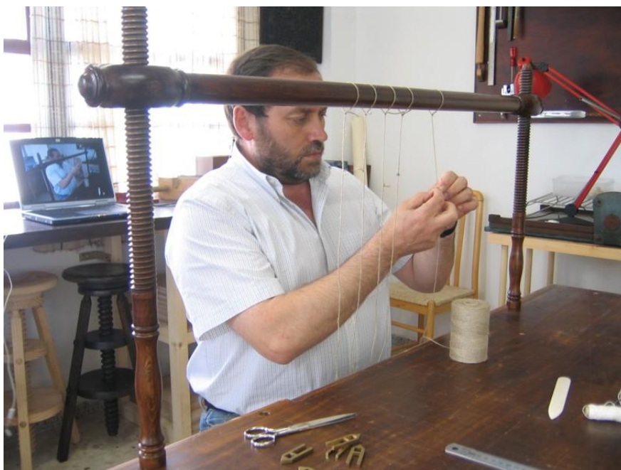
Colocación de las cuerdas
